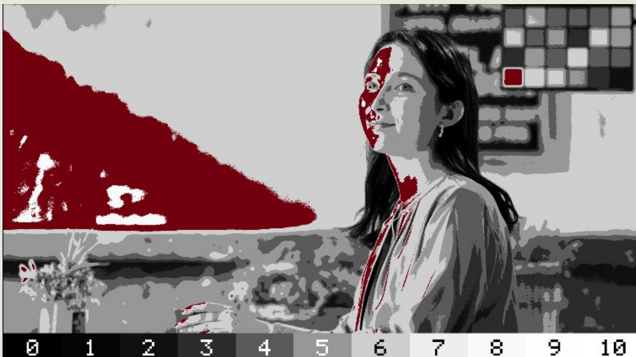
Escalera de grises + leyenda 0–10. Aquí Isolate Zone aísla una zona alta, pintada de rojo (rostro, cafetera, cielo).
